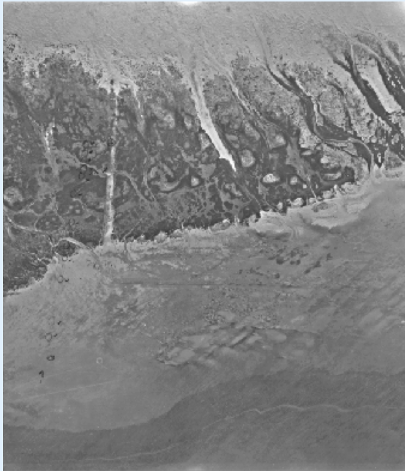
Figuur 5.26: Luchtfoto van de kwelder De Hon (13 mei 1984). Centraal is het traject zichtbaar waar de zandpersleiding heeft gelegen voor aanleg van de locatie. De pijpleiding blokkeerde een belangrijke afwateringskreek die vervolgens verlandde (foto KLM Aerocarto).
