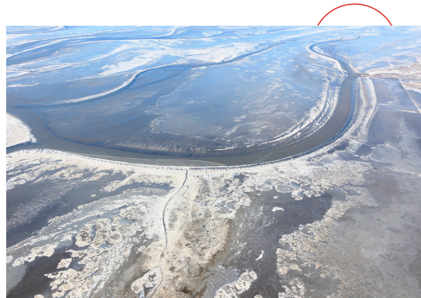
5.13. Baggeren kan geulen uit evenwicht brengen. De natuurlijke geul ten oosten van Holwerd is sinds de jaren '80 ondieper en smaller geworden en nu een kleine priel, zie de rode cirkel en figuur 5.14. Op de voorgrond de gebaggerde geul bij Holwerd, zichtbaar uit evenwicht met de natuurlijke situatie. Bron: Rijkswaterstaat.
