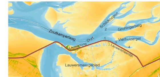
5.15. De geul Vierhuizergat ondermijnde de Lauwersmeerdijk. Bron: Jelmer Cleveringa (op basis van vaklodgingen van Rijkswaterstaat).
