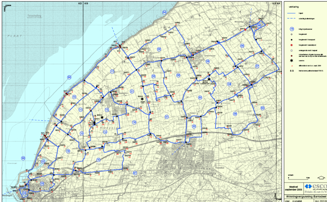
Figuur 6. Het meetnet dat door Oranjewoud gebruikt wordt voor jaarlijkse waterpasmetingen
