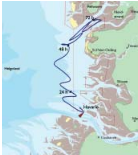
Simulation eines Tankerunglücks in der Elbmündung – Das auslaufende Öl driftet ins Wattenmeer.
